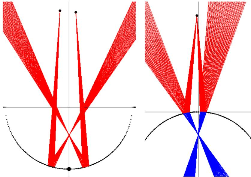
Im linken Bild haben wir Reflexion an einer Hohlkugel. Wir sehen einen reellen Fokuspunkt etwa im Abstand des halben Kugelradius auf der Achse. Das zweite Bild zeigt die Reflexion an einer Vollkugel. Rot die tatsächlichen Lichtwege und blau die Verlängerung der reflektierten Strahlen. Wir sehen einen virtuellen Fokuspunkt erneut mit einem Abstand des halben Kugelradius vom Mittelpunkt.
