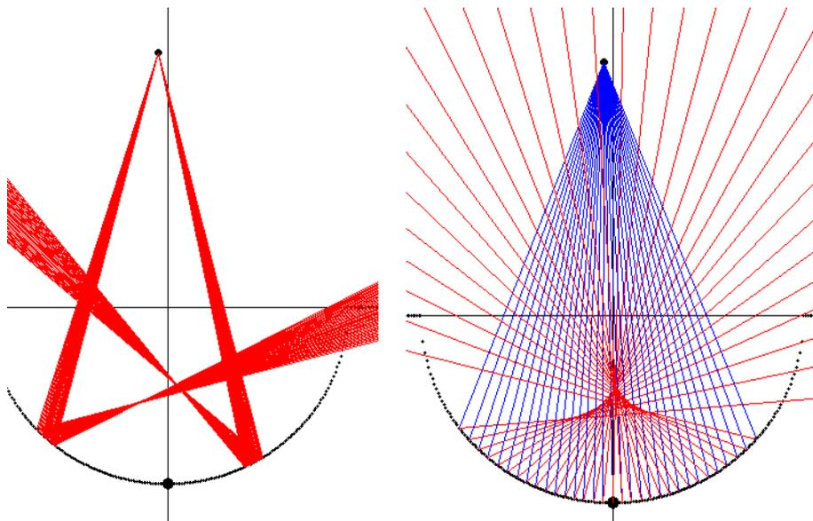
Im rechten Bild geht von dem Punkt ein breites (blaues) Bündel aus. Die reflektierten Strahlen sind rot gezeichnet. Wir sehen, dass sie nicht mehr durch einen Punkt gehen, aber so etwas wie eine Figur hoher Dichte erzeugen. Das ist in gewissem Sinne die Figur - der geometrische Ort - aller Fokuspunkte schmaler Bündel.
