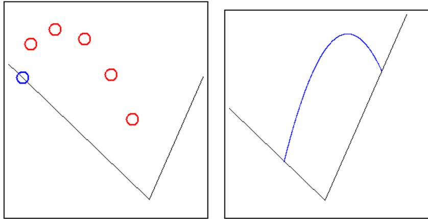
**2. Computersimulation:** Das rechte Bild zeigt das Stück einer Parabelbahn, das zwischen zwei Reflexionen durchlaufen wird. Also eine Dauerbelichtung zwischen zwei Reflexionen!
