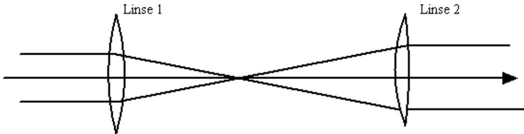
Wie sind die beiden Linsen entlang der optischen Achse angeordnet? Beschreiben Sie das (kurz) und ergänzen Sie die Skizze geeignet.
