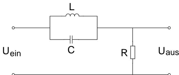
**a)** Bestimmen Sie die Ausgangsspannung  $U_{\text{aus}}(t)$ , und diskutieren Sie den Stromfluss für die beiden Grenzfälle  $\omega = 0$  und  $\omega \rightarrow \infty$ .
